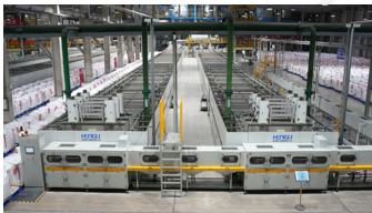
六列三层辊道炉正极材料产线
